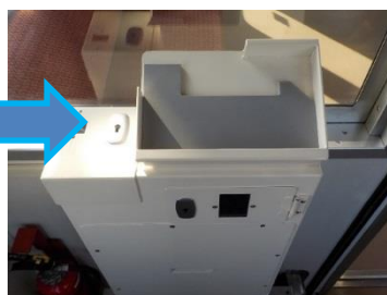
列車の運転台に設置する放送装置
